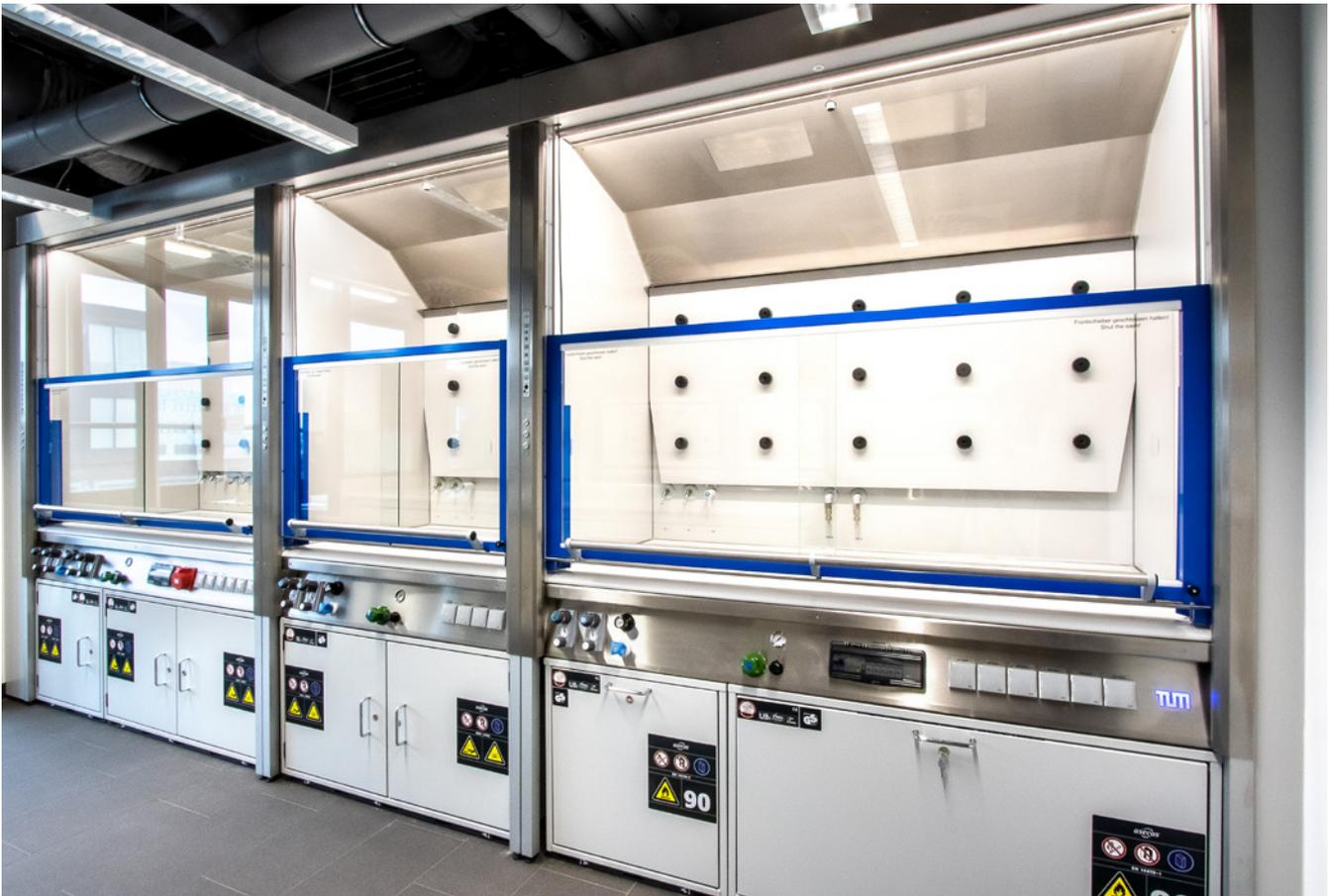
Ein Laborabzug, Tischabzug oder auch Digestorium genannt, ist eine Vorrichtung zum Schutz von Forschenden vor Gasen, Stäube, Aerosole, Splitter und spritzenden Flüssigkeiten. Die Abzüge werden nach DIN EN 14175 gebaut, geprüft und zertifiziert.
