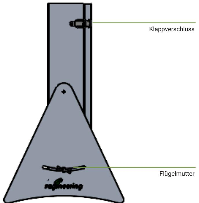
Gefertigt aus V2A Edelstahl K240 geschliffen mit seitlichen Klappverschlüssen zum Öffnen und Schließen der Abdeckung zum Sichtfenster. So wird eine dunkle Atmosphäre für das Pflanzenwachstum geschaffen.
