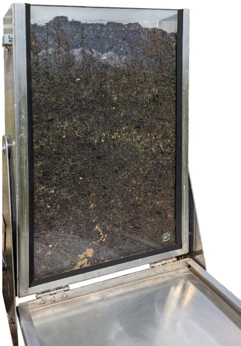
Mobiler Rhizotron zur Untersuchung des Bodens und dessen Wechselwirkungen mit Pflanzen und Tieren. Das Sichtfenster ermöglicht es, jederzeit das Wurzelwachstum oder die Bodenbeschaffenheit zu überprüfen und zu beobachten.
